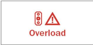
**GEFAHR** Im Falle einer Überlast muss die auf dem Sensor lastende Kraft unbedingt vollständig aufgehoben und geprüft werden, dass das Produkt erneut Null anzeigt.
